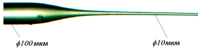
Рис. 3 Микроскопный вид микро-сужения оптического волокна
