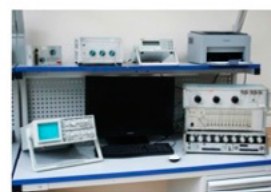
СТА-1 для тензоаппаратуры Диапазон — до 100 кГц Погрешность — 0,08%
