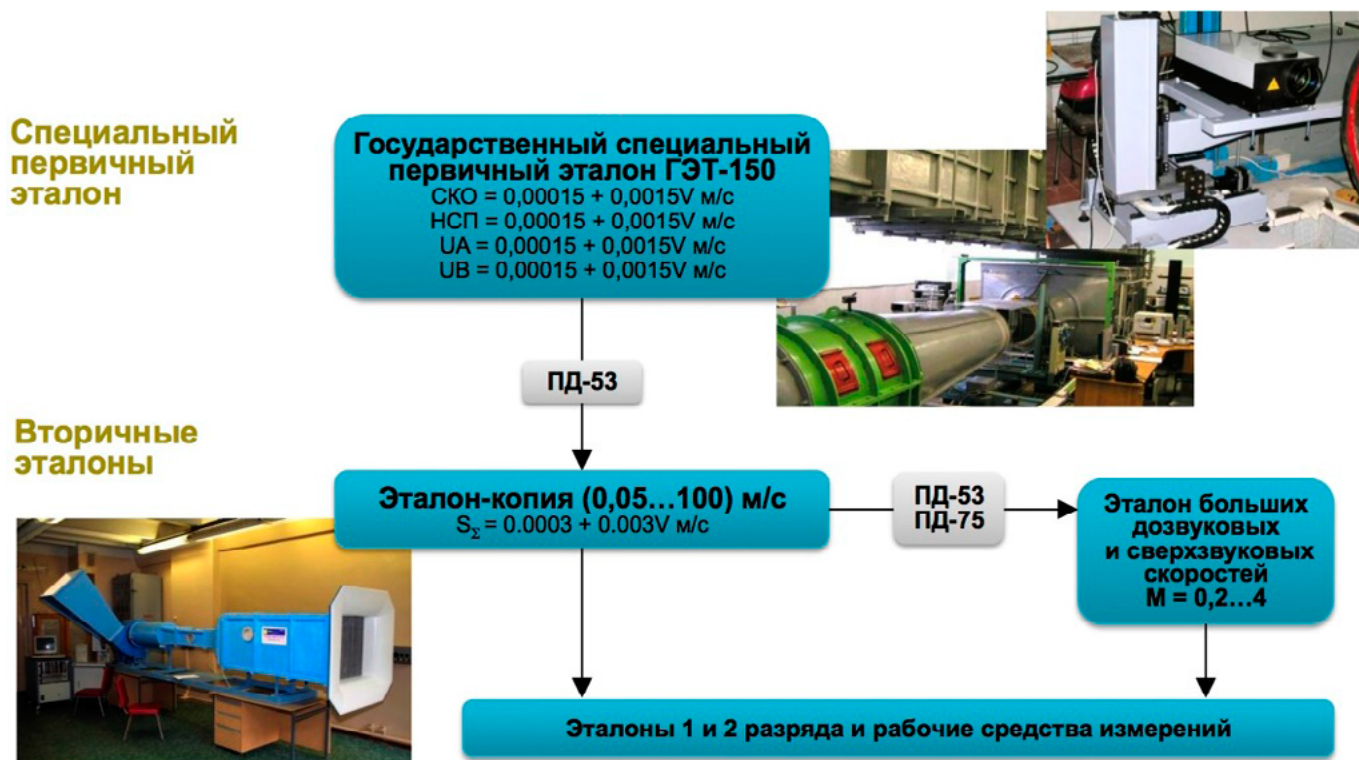
Рис. 10. Новая государственная поверочная схема для средств измерения скорости воздушного потока (ГОСТ Р 8.542-20...)
