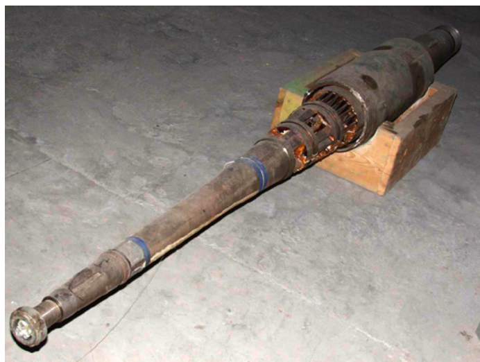
Рис. 2. Внемоделные весы 6ЭВ-128 3(1). Y = 20 кН
