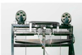
УГТ-1 деформации тензорезисторов Диапазон — 3000·млн -1 Погрешность — 0,5%
