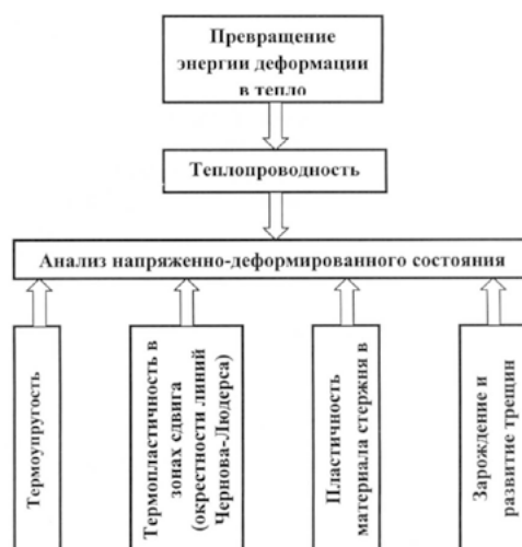
Рис. 1. Схема взаимозависимости тепломеханических процессов, рассматриваемых при моделировании напряженно-деформированного состояния стального изделия
