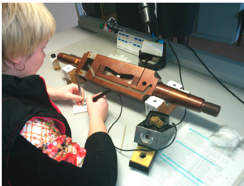
Рис. 14. Наклейка и монтаж весов на ленточной подвеске
