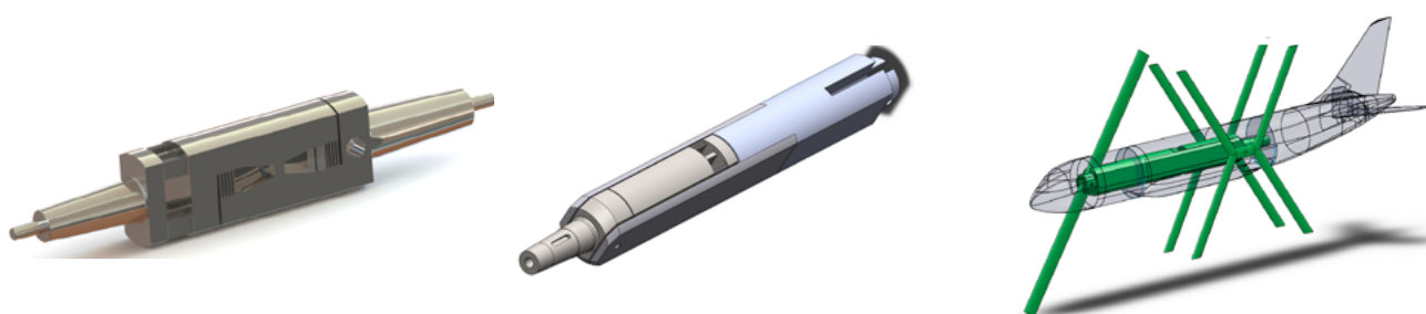
Рис. 13. Ленточные весы. Весовой элемент (слева), тензовесы в сборе (по центру), компоновка тензовесов с моделью (справа)
