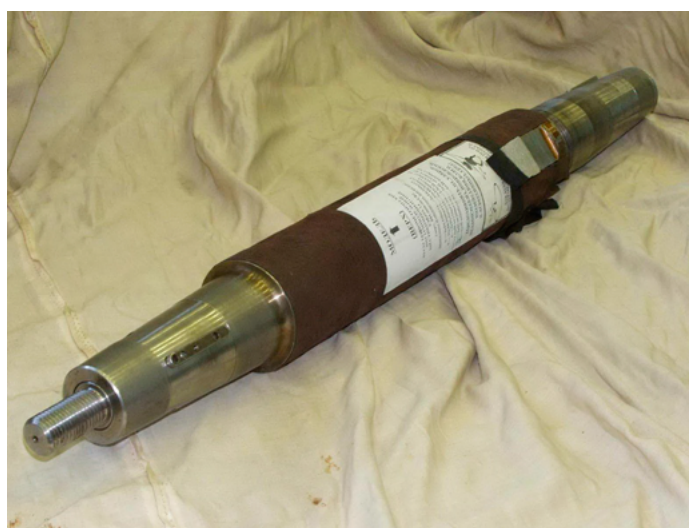
Рис. 4. Шестикомпонентные внутримодельные тензоскопы для испытания моделей пассажирских самолетов. Y = 20 \text{ кН}
