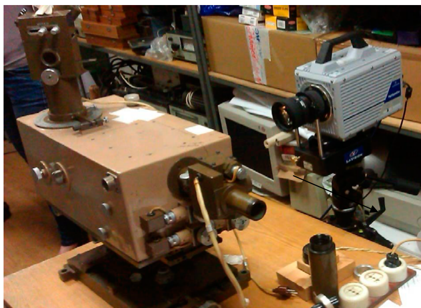
Рисунок 3 – Часть экспериментальной установки с реализацией интерферометра для контроля измерений
