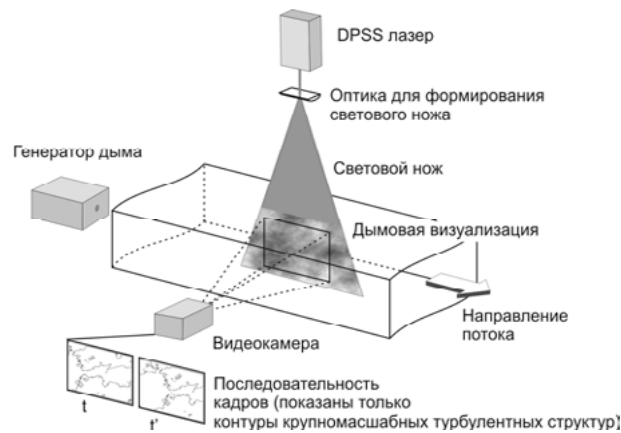
Рис. 1. Экспериментальная установка для измерения поля скорости в канале
