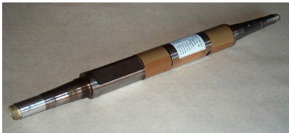
Рис. 5. Внутримодельные шестикомпонентные весы для испытания моделей ракет Y = 5,5 \text{ кН}
