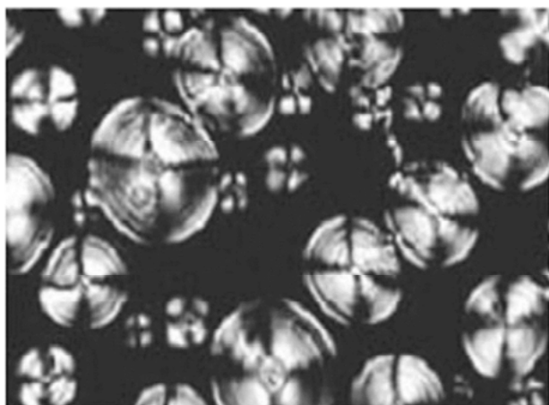
Рис.7. Морфология полимерно-жидкокристаллической пленки
