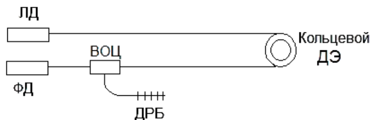
Рис. 4 Структура ВОДАЭ с внутрисветоводным демодулятором на ДРБ
