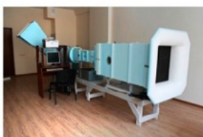
ЭМС-0,1/60 — единица скорости воздушного потока Диапазон: 0,1–60 м/с Погрешность: \pm(0,006+0,0005V)
