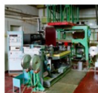
Комплекс ГС для тензовесов Диапазон: от 10 Н до 40 кН Погрешность: 0,05...0,1%
