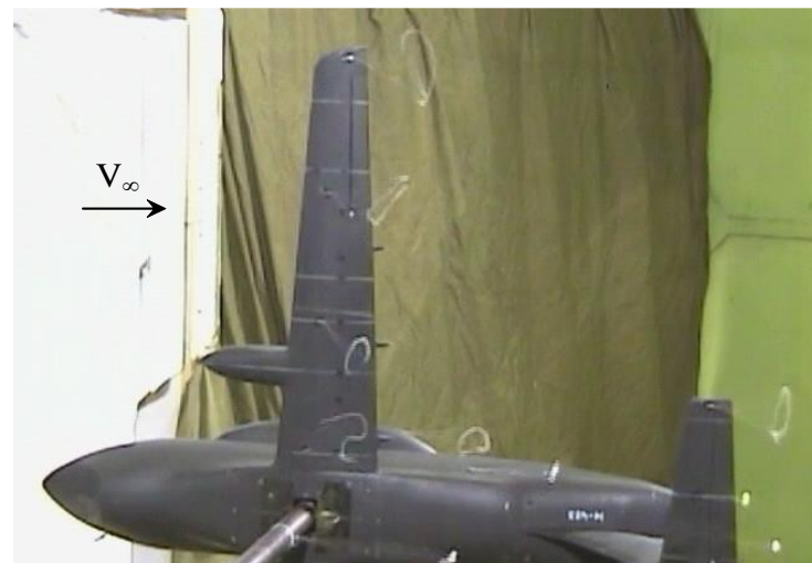
Схема расположения нитей на поверхности крыла и картина обтекания модели самолета
