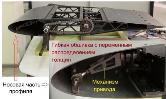
Рис. 1. Профиль с адаптивным управлением контура носка и законцовки крыла
