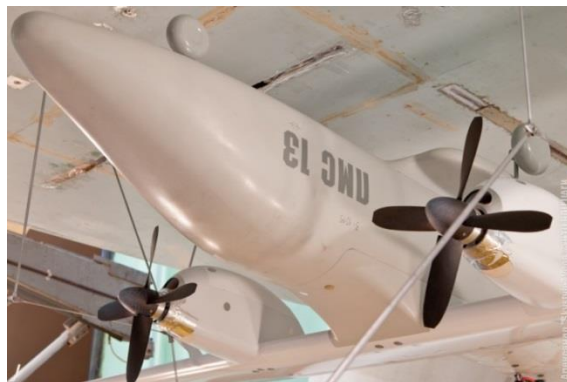
Рис. 2. Модернизированная модель легкомоторного самолета с имитаторами силовых установок для аэродинамических исследований в АДТ Т-102
