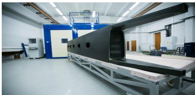
Рис. 1. Демонстратор силовой части крыла самолета малой авиации из полимерных композиционных материалов на фоне термоинфузионного автоматизированного центра
