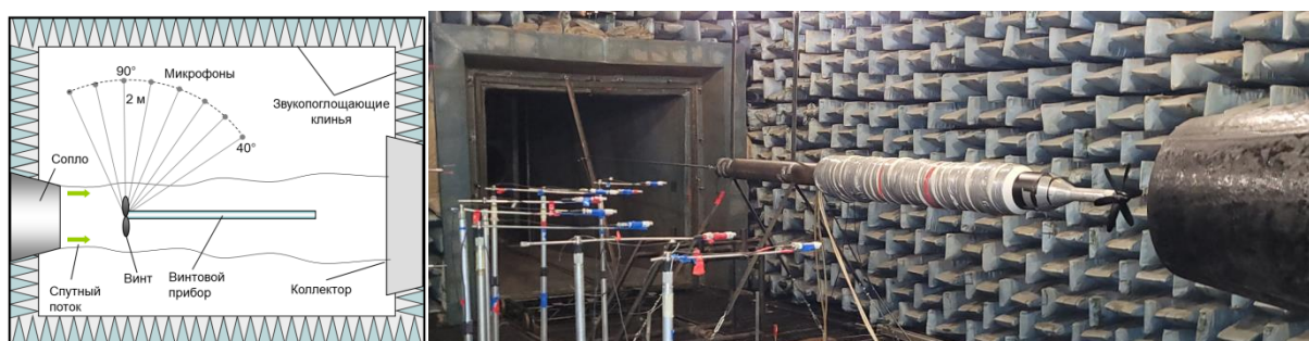
Рис. 1. Испытания винтового прибора с маломасштабным винтом в заглушенной камере АК-2 ЦАГИ: схема эксперимента (слева), фото эксперимента (справа)
