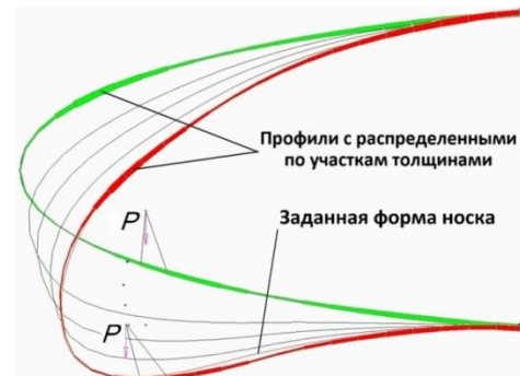
Рис. 4. Деформация профиля с расчетным распределением толщин на заданных участках профиля
