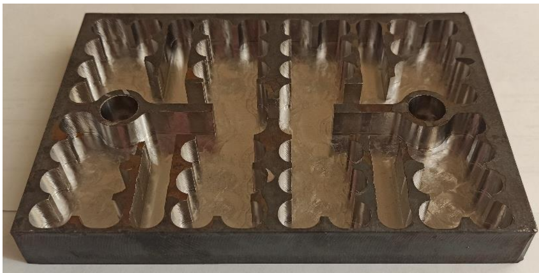
Рис. 1. Карман сложной формы для обработки в технологическом эксперименте.
