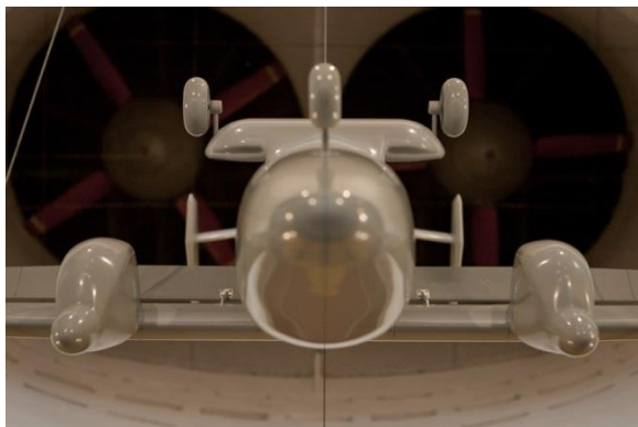
Рис. 1. Аэродинамическая модель с гладкими мотогондолами для аэродинамических исследований в АДТ Т-102
