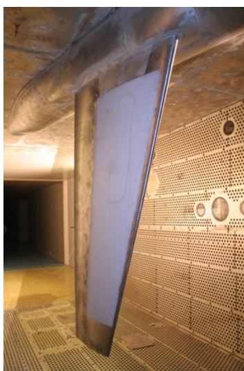
Рис. 1. Тематическая полумоделка в АДТ Т-128, нижняя поверхность
